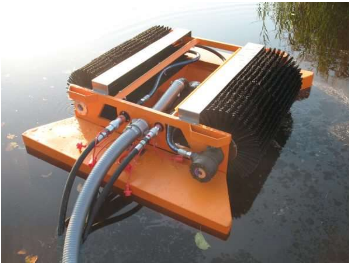
Скиммер для сбора нефти и нефтепродуктов
